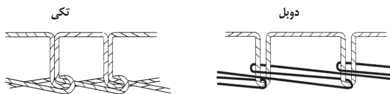
شکل ۲۲- ۱ دو نوع کوک‌زنی (تکی و دوبل)
