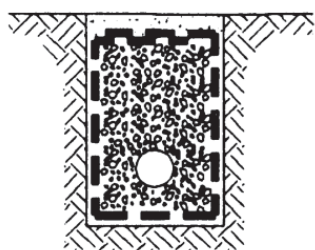
۶- اجرای خاکریز باقیمانده روی کانال و تراکم
