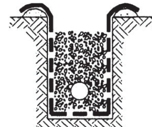
۴- ریختن مصالح زهکشی و تراکم
